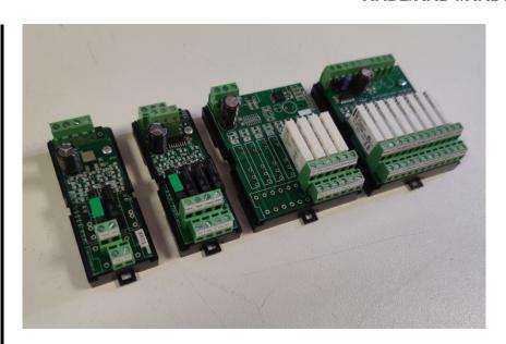
El modulo XRD2/4/8 es un driver de 2/4/8 entradas analogicas de 0-10V de baja corriente, que permite activar dos, cuatro u ocho salidas de reles con tensiones apartir de los 1.5 V. Cada salida de rele dispone de un contacto NO ( opción –S ,SPST ) o NO/NC ( opción –D SPDT ) y led indicador de estado.
