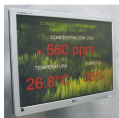
PPA10 con Sonda exterior de Temperatura , Humedad y CO2.
