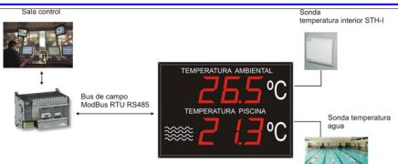
**DTTP-EA** permite conectar dos entradas analógicas externas para la temperatura interior y exterior . Incluye cable alimentación.
