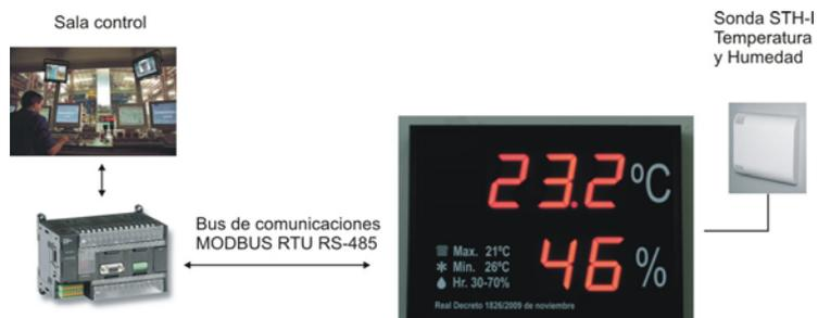
**DTH-C-TCP** Recibe los datos de temperatura y humedad a través de un bus de comunicaciones Modbus TCP. Incluye cable alimentación.
