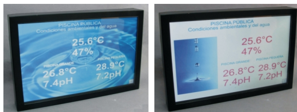
PTH5-P con Sonda exterior STH-I, 2 sondas NTC y 2 sondas pH en contacto con el agua de la piscina.
