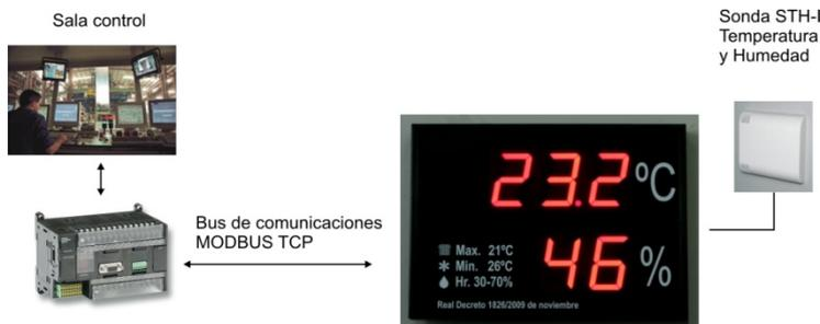
**DTH-EA** ermöglicht den Anschluss von zwei externen analogen Eingängen für Temperatur und Feuchtigkeit. Inklusive Netzkabel.
